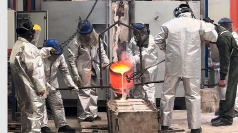
Figura 9. Puesto de trabajo transportadores de crisol.
